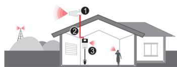
1-Antenna direttiva a banda larga per esterno 2-15,2m Hiboost200 cavo a bassa perdita 3-Amplificatore Hiboost con antenna integrata
