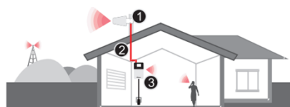
1-Antena direccional de banda ancha para exteriores 2-50pies (15.2m) de cable de baja pérdida HiBoost200 3-Amplificador HiBoost con antena incorporada
